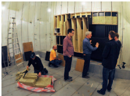
Ljudmätningar med mondrianska element på DTU. Här monteras lådor i efterklangsrums.
