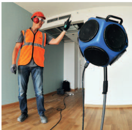
Bullermätning mellan hotellrum. Detta blir Malmös största hotell med 444 gästrum, och vi bygger för ljudklass B.
