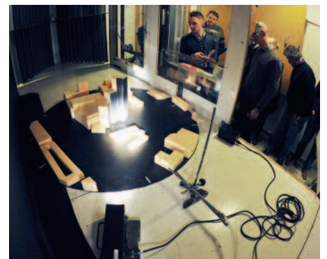
Vindtunnelförsök med en skalmmodell av projektet för att bestämma rättvisande vindpåverkan på vår aktuella struktur. Försöken innefattar bestämning av vindtryck, formfaktorer, dynamiska effekter, vibrationsbeteenden och komfortbedömning.
