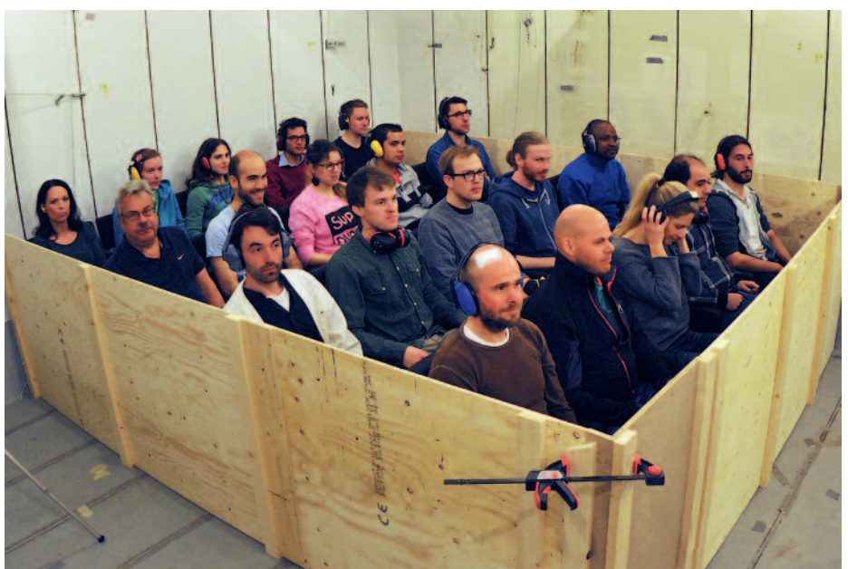
Här ser vi absorptionsmätning av stolar med publik, där merparten är studenter från sista årskursen på DTU Acoustic Technology, under ledning av professor Jonas Brunskog och professor Cheol-Ho Jeong. Mätningen utfördes av Anders Gade.
